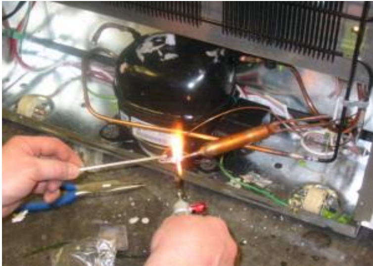
Soldando motor de refrigeradora
