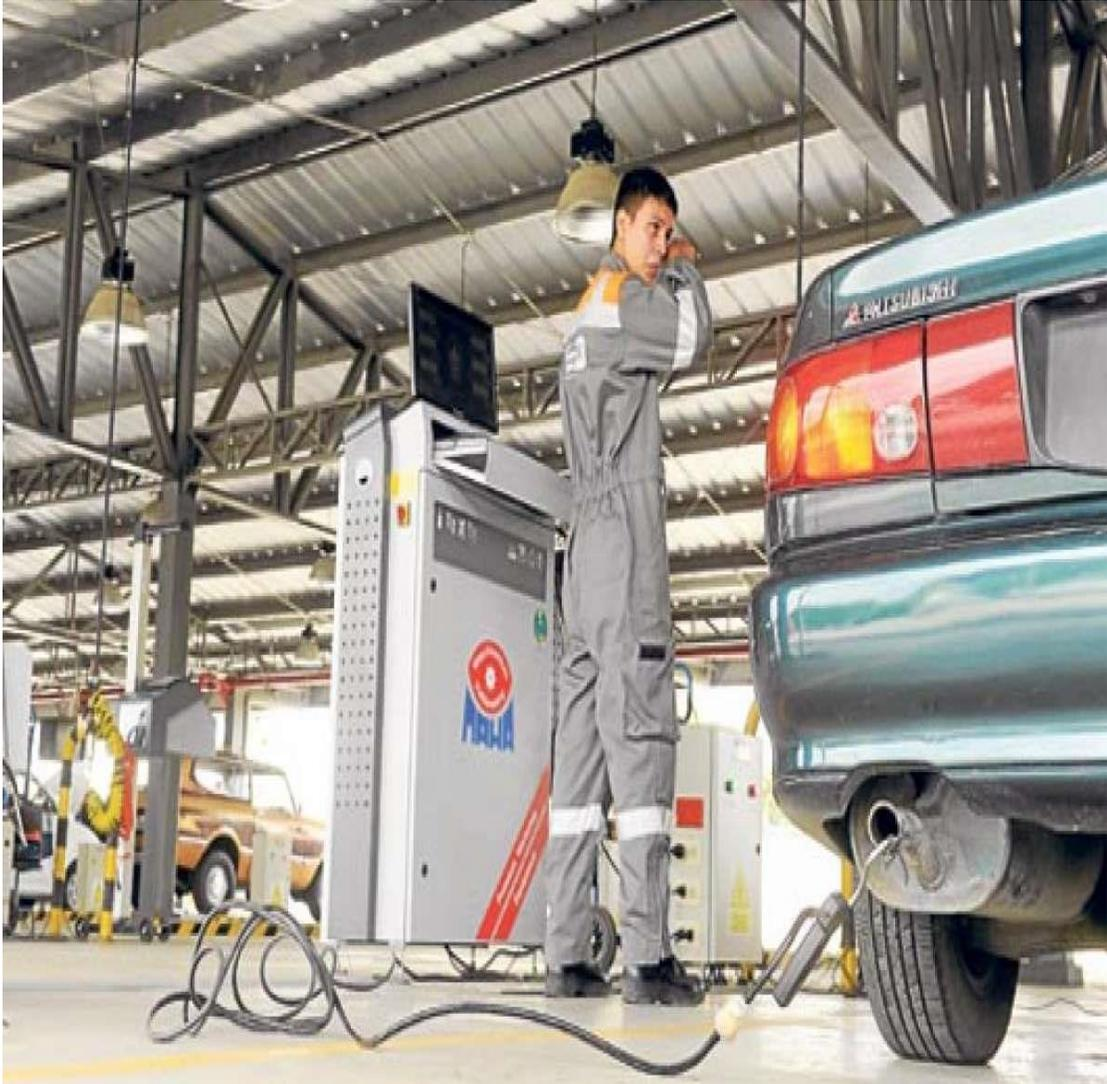
*Prueba de emisiones de gases contaminantes por el sistema de escape de los vehículos*
