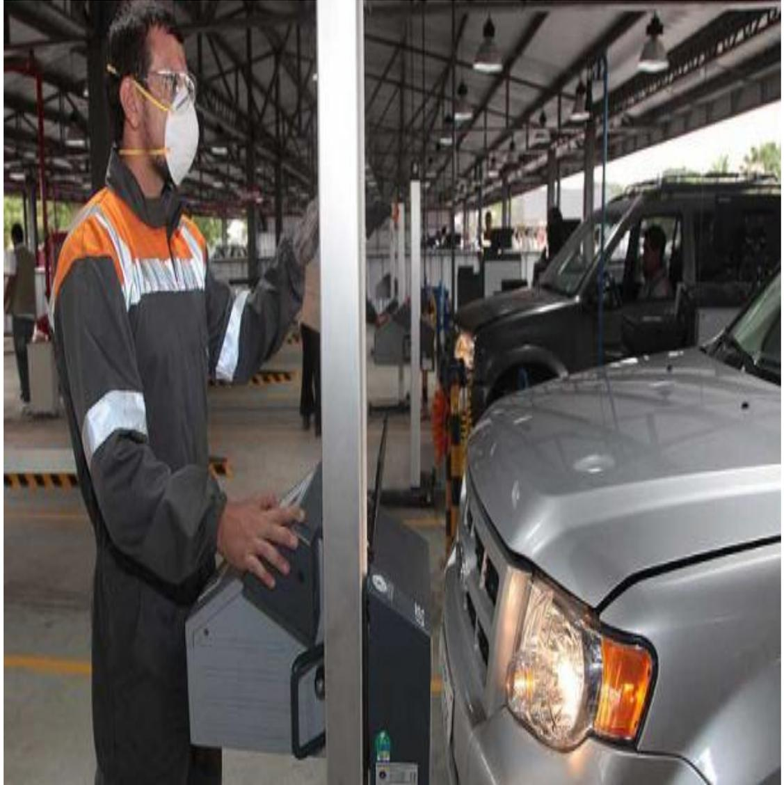
*Revisión de la medición de intensidad y alineación de faros frontales del eje vertical y horizontal*
