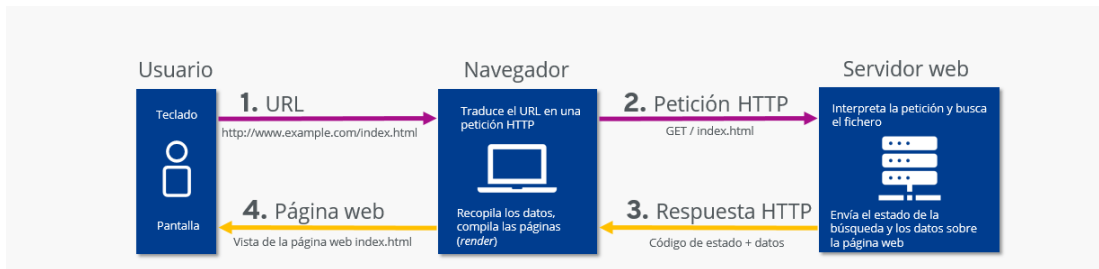
Ilustración 6 Proceso de comunicación por http
