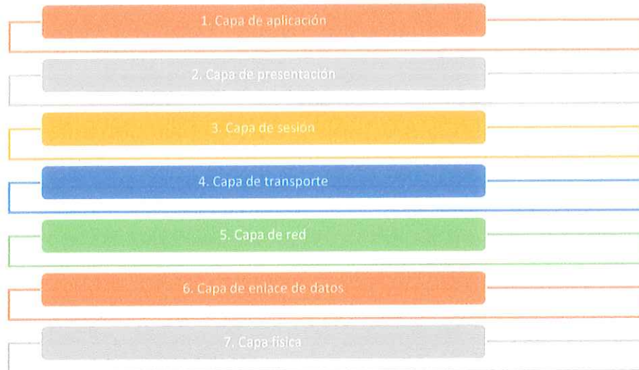
Figura 3_Capas en el Modelo OSI
