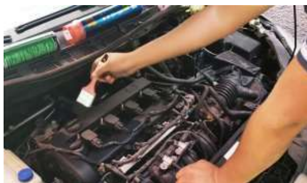
Figura 16. Limpieza de techo, aros y motor Elaborado por: Granda, J. (2021)
