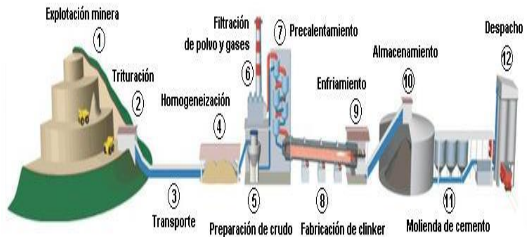
Gráfico 4: Proceso de fabricación de la empresa Holcim S.A.
