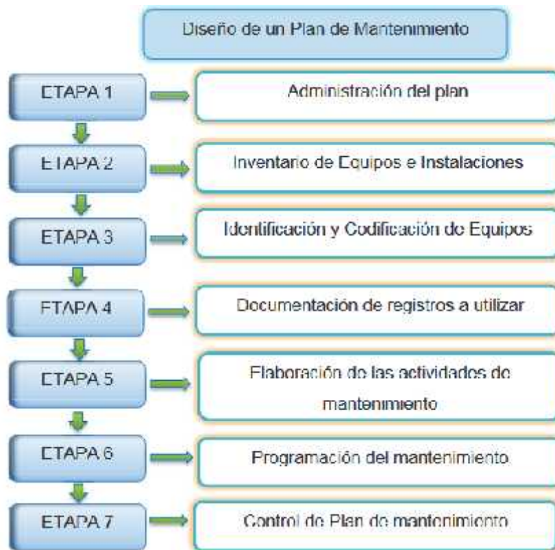
Figura 2. Etapas de mantenimiento
