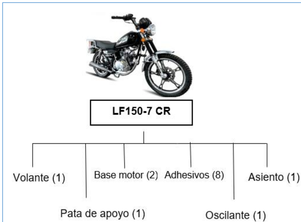
Figura 4.25 Partes y piezas de la moto LF150-7 CR
