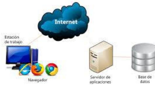
Figura 2: Esquema de una aplicación web
