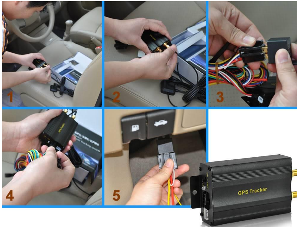
Figura 48: Instrucciones de Instalación del GPS Trackers Fuente: Localizador GPS Trackers
