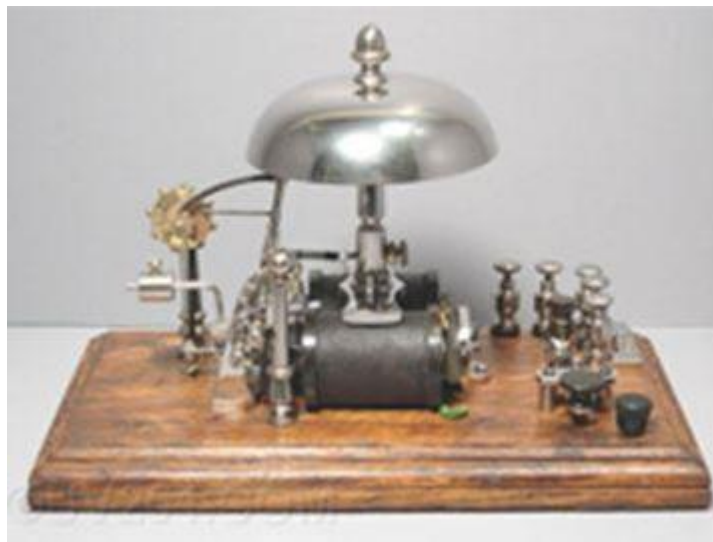
Figura 4: Sistema de Alarma Versión Pope
