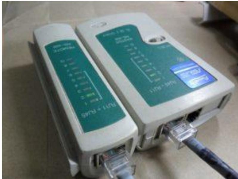
Gráfico 35 Comprobación del funcionamiento del cable de red
