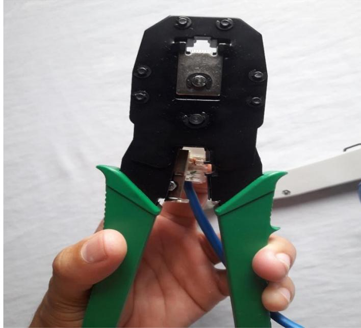
*Gráfico 42 Corte del excedente del cable en el conector
