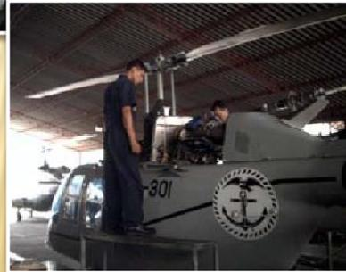
**PERSONAL DEL DEPARTAMENTO DE MECANICA Y ESTRUCTURAS DE ALA FIJA DEL ESCMAN DURANTE EL DESMONTAJE DE LOS MOTORES Y HELICES DEL AN-236**
