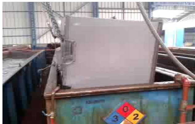
Figura 4.16. Pre-tratamiento con cadenas
