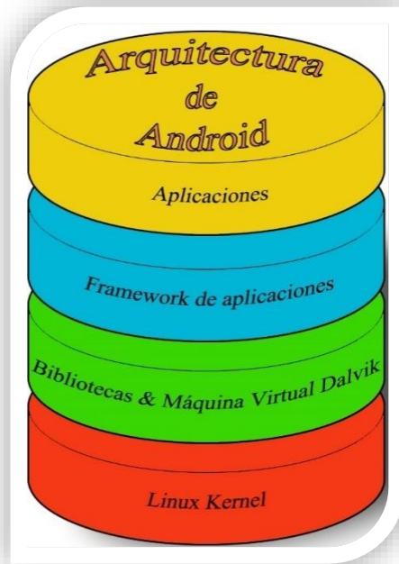
Gráfica 3 Arquitectura Del Sistema Operativo Android Fuente: El Gran Libro De Android
